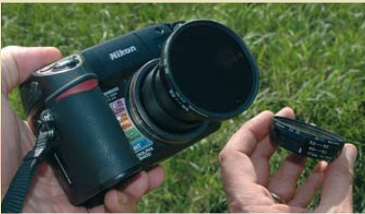
La Coolpix 8400 con il filtro Heliopan Infrarot 715 che è stato montato direttamente sulla filettatura dello zoom della fotocamera, utilizzando alcuni anelli di riduzione.
