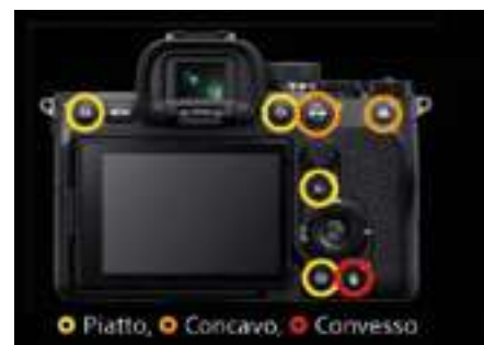
I tasti funzione di una Sony Alpha sono differenziati per facilitarne il riconoscimento al tatto
